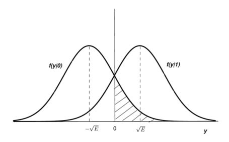
Рис. 1.2. Условные распределения значений на выходе канала при передаче символов 0 и 1 противоположными сигналами
