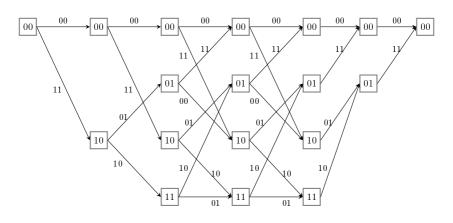
Рис. 8.10. Решетка усеченного сверточного кода
