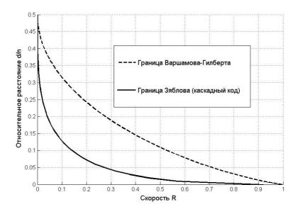
Рис. 10.4. Граница Варшамова—Гилберта и асимптотическая граница на относительное расстояние каскадных кодов
