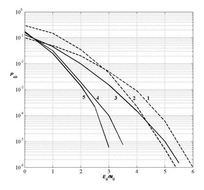
Рис. 8.9. Вероятность ошибки на бит в гауссовском канале для блоковых и сверточных кодов:
