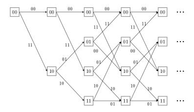
Рис. 8.4. Решетчатая диаграмма сверточного кода
