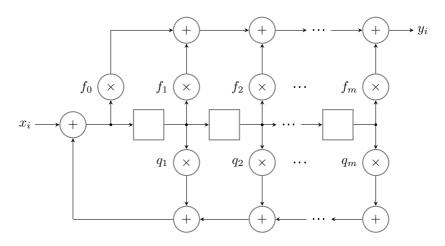
Рис. 9.2. Каноническая форма цифрового фильтра с вынесенными сумматорами (controller canonical form)
