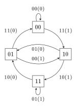
Рис. 8.5. Диаграмма состояний кодера сверточного кода
