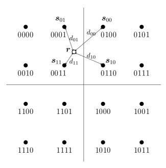
Рис. 10.16. Вычисление метрик при декодировании сверточных модуляционных кодов
