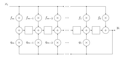
Рис. 9.3. Каноническая форма цифрового фильтра со встроенными сумматорами (observer canonical form)
