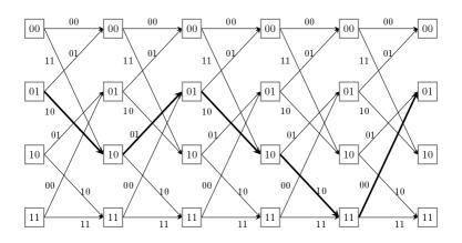
Рис. 8.13. Решетка циклически усеченного сверточного кода
