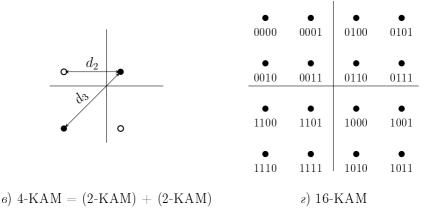
Рис. 10.13. Разбиение сигнального множества на подмножества
