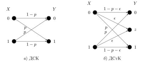
Рис. 1.1. Примеры каналов: a — двоичный симметричный канал (ДСК);  $\delta$  — двоичный канал со стираниями (ДСтК)
