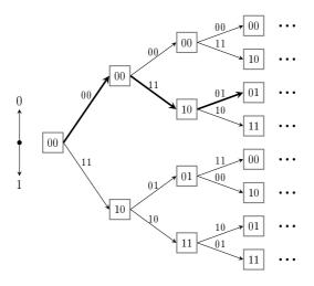
Рис. 8.3. Представление сверточного кода в виде дерева
