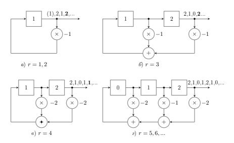
Рис. 7.3. Построение фильтра по заданной последовательности
