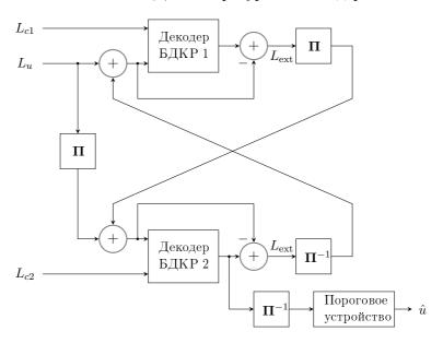
Рис. 10.9. Декодер турбо-кода
