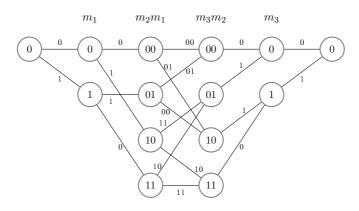
Рис. 4.6. Секционированная решетка кода примера 4.4
