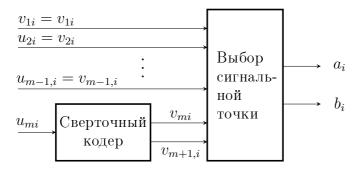
Рис. 10.15. Кодер системы с кодированной модуляцией с разделением битов на кодируемые и некодируемые
