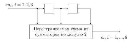
Рис. 4.7. Кодер на основе конечного автомата 4.4
