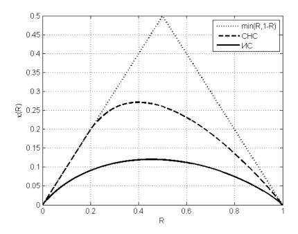
Рис. 2.1. Границы экспоненты сложности декодирования:  $\min(R, 1-R)$  — декодирование перебором по кодовым словам либо синдромное декодирование; «СНС» — декодирование по соседям нулевого слова; «ИС» — декодирование по информационным совокупностям
