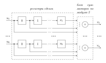
Рис. 8.1. Сверточный кодер со скоростью R = k/n
