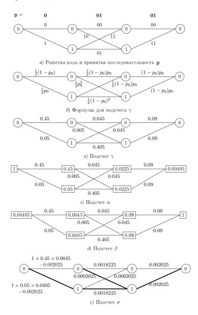
Рис. 4.9. МАП-декодирование по алгоритму БКДР для кода примера 4.6
