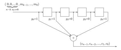
Рис. 5.3. Несистематический кодер циклического кода
