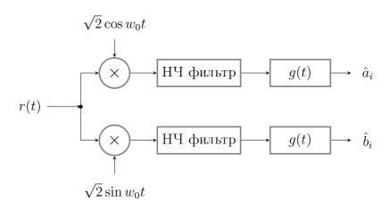
Рис. 10.12. Демодулятор сигналов КАМ
