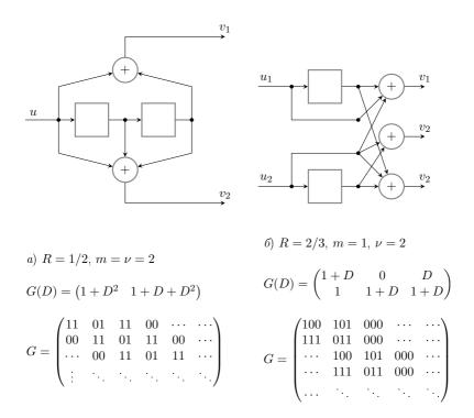
Рис. 8.2. Примеры сверточных кодеров
