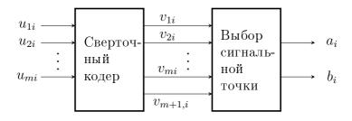
Рис. 10.14. Кодер системы с кодированной модуляцией на основе сверточного кода
