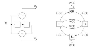
Рис. 8.6. Катастрофический кодер и его диаграмма состояний
