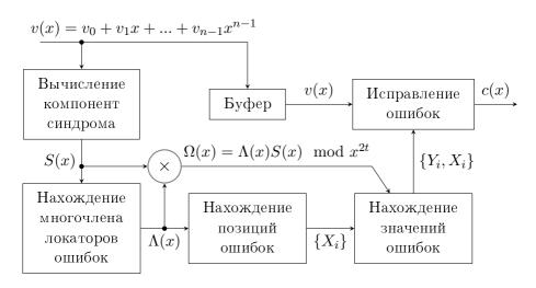
Рис. 7.2. Блок-схема декодера БЧХ-кода
