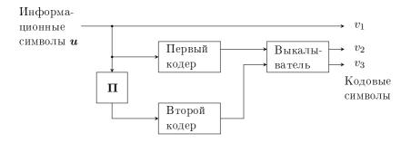
Рис. 10.6. Схема кодера турбо-кода
