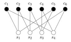
Рис. 11.2. Граф Таннера для кода примера 11.3
