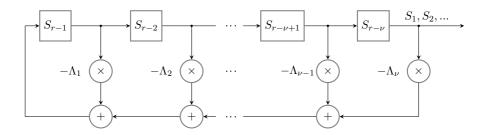
Рис. 7.1. Интерпретация вычисления многочлена локаторов ошибок как построения БИХ-фильтра
