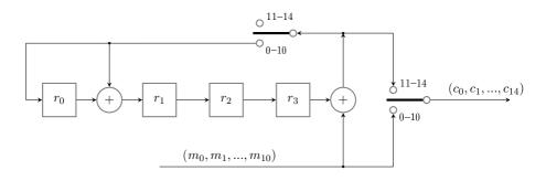
Рис. 5.4. Систематический кодер кода (15, 11)
