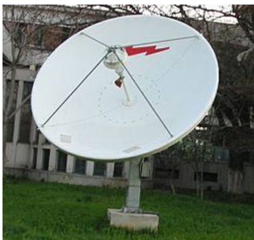
Спутниковая антенна для C-диапазона
